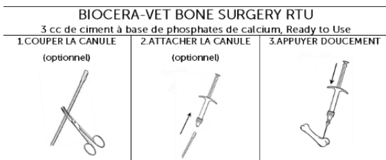
Fig. 3: Utilisation de la canule avec le substitut osseux à base de phosphates de calcium RTU de 3 cc
